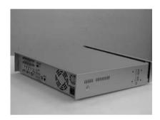
3. 左右にブラケット (HDDブラケット) があります。ここにHDDを取り付けることができます。 HDDを取り付けるブラケットを留めているネジを外します。
